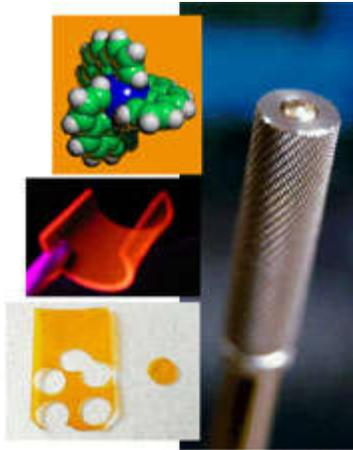
*Sensor químico luminiscente sobre fibra óptica, fabricado por la Universidad Complutense de Madrid, para la medida del oxígeno disuelto.*
