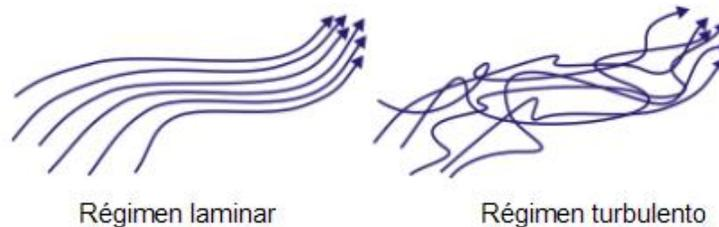
Laminar: las capas vecinas de fluido se deslizan entre si suavemente en forma ordenada, siguiendo líneas de corriente que no se mezclan y en las que la velocidad, vector tangente a la trayectoria de cada partícula de líquido, está totalmente determinada.
