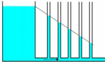
CIRCULACIÓN DE FLUIDOS REALES EN TUBOS CILÍNDRICOS.
