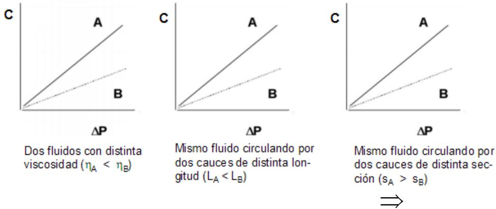
Cuando un líquido homogéneo circula por tubos rígidos, la relación entre C y  $\Delta P$  es lineal y para cualquier  $\Delta P$  hay flujo de líquido.
