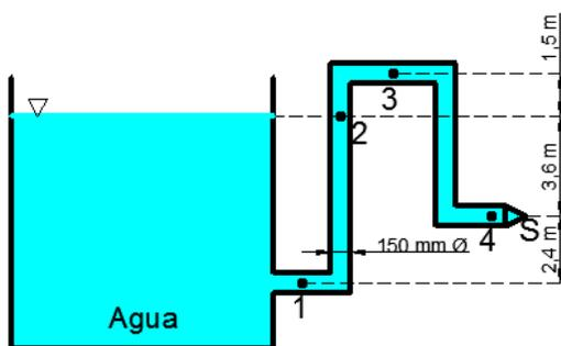
Para el sifón de la figura determine el caudal desaguado y la presión en los puntos 1, 2, 3, 4. La presión barométrica local vale  $10,33 \text{ mca}$ . El fluido circulante es agua. Diámetro del chorro  $50 \text{ mm}$ . Se desprecian las pérdidas.
