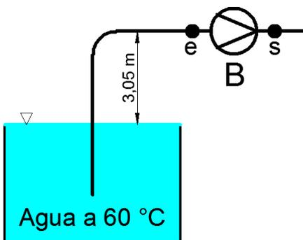
Pérdidas en tubería de aspiración  $H_{r_{\nabla e}}$
