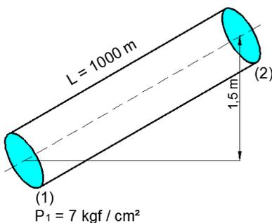
$$Q = 22,08 \text{ lts} / \text{seg} \quad \text{Diámetro } 150 \text{ mm}$$
