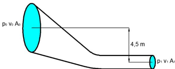
La presión se puede encontrar mediante la ecuación de Bernoulli, pero previamente necesitaremos calcular la velocidad  $v_1$  con la ecuación de continuidad.
