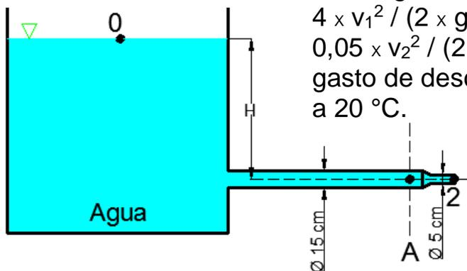
En la figura las pérdidas hasta la sección A valen  $4 \times v_1^2 / (2 \times g)$  y las pérdidas en la boquilla valen  $0,05 \times v_2^2 / (2 \times g)$ . Determine la presión en A y el gasto de descarga si  $H = 8 \text{ m}$  y el fluido es agua a  $20 \text{ °C}$ .
