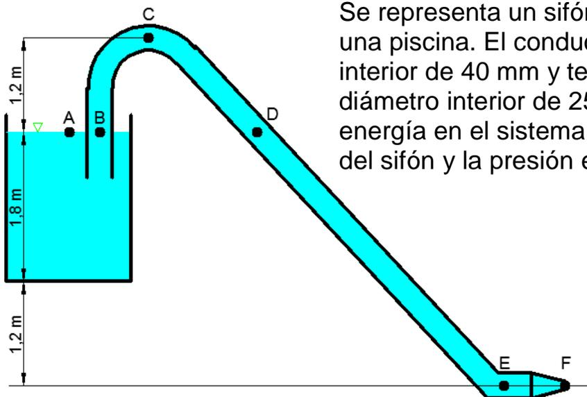
Se representa un sifón para sacar agua de una piscina. El conducto tiene un diámetro interior de 40 mm y termina en una boquilla de diámetro interior de 25 mm. No hay pérdidas de energía en el sistema. Calcular el flujo a través del sifón y la presión en los puntos B, C, D, E.
