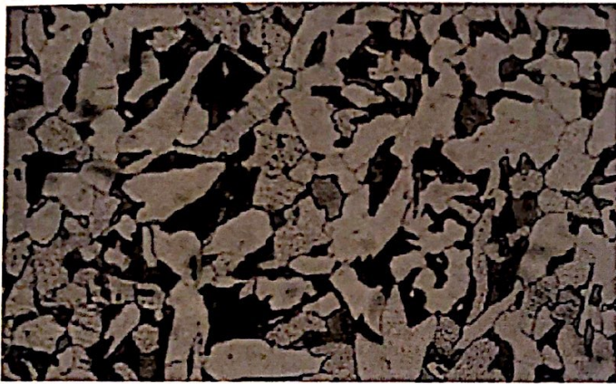
Figura 2.44. Microestructura de un acero al carbono A285 (0,18 C, 0,43 Mn, 0,009 P, 0,026 S). Ferrita (gris claro) y perlita (gris oscuro).
