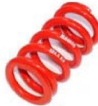
Figura 2.9. El límite elástico de un muelle de suspensión suele ser de unos 1.800 N/mm 2 aproximadamente.
