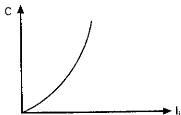
Figura 20.12. Característica de par motor de un motor serie.
